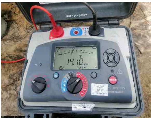
ค่าความเป็นฉนวนระหว่างขดลวดแรงสูงกับแรงต่ำ:HV-LV
