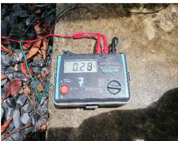
ค่าการวัดจุดต่อลงดินของตัวถัง (Tank)
